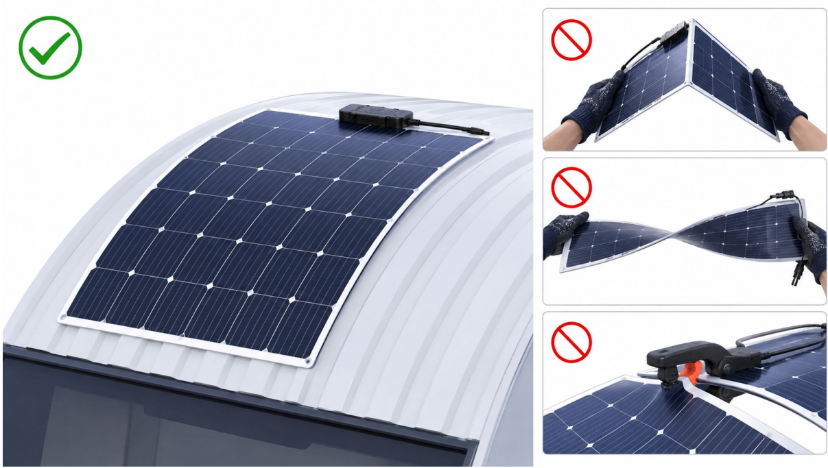
Şekil 3 - Doğru kavis ve yasaklı deformasyonlar: geniş tek eksenli kavis uygundur; keskin katlama, burma ve noktasal sıkıştırma yasaktır.
