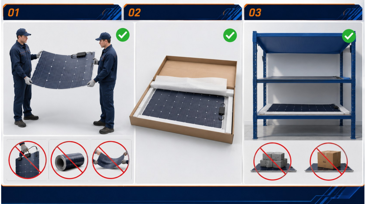
Şekil 1 - Güvenli taşıma ve depolama: geniş yüzeyden iki kişiyle destekleme, koruyucu ambalaj ve yüksüz düz raf.
